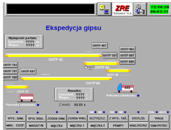
Rys 4. Ciąg transportowy dla załadunku gipsu na samochody i wagony.
