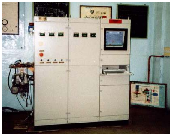
Rys.1 Stanowisko badawcze dla zaworów rozrządczych wielu systemów
