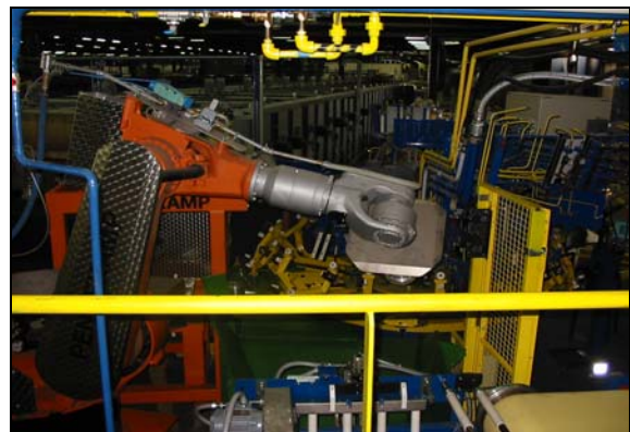
Rys.2 Wtapiarka Anod – Załadunek stożka
